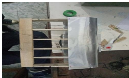
Gambar 7. Tampak Atas Prototype Anti Icing Pada Air Foil Clark Y Berbasis Arduino
