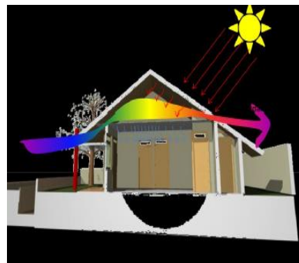
Gambar 10. Ventilasi atap pada plafond
