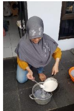
Gambar 3. Pencampuran Larutan Kanji dan Bubur Kertas
